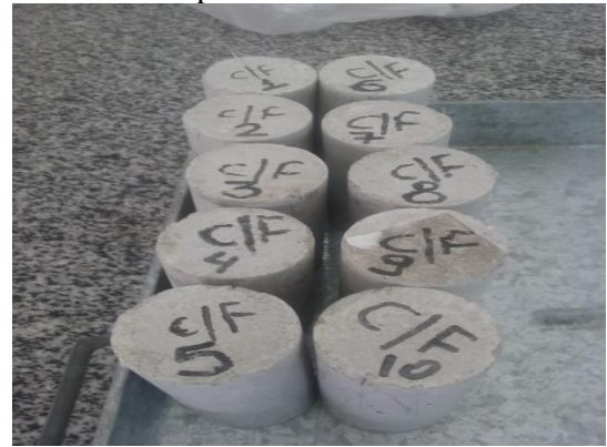
Figura 12: Cura dos corpos de provas moldados para ensaio de resistência.
