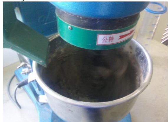
Figura 10: Mistura mecânica da argamassa com Argamassadeira eletromecânica (Contenco - Modelo I 3010).
