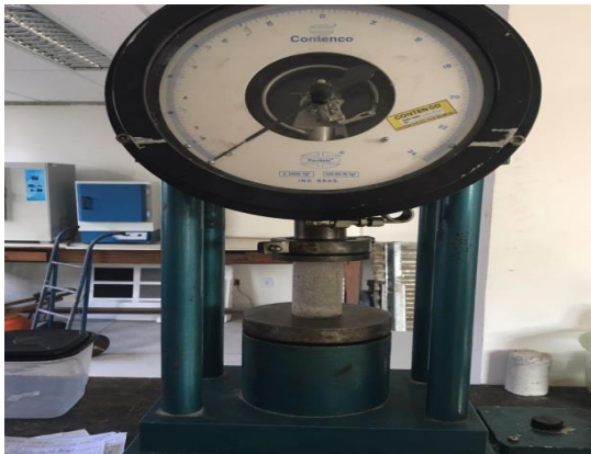
Figura 13: Prensa Hidráulica para rompimento.
