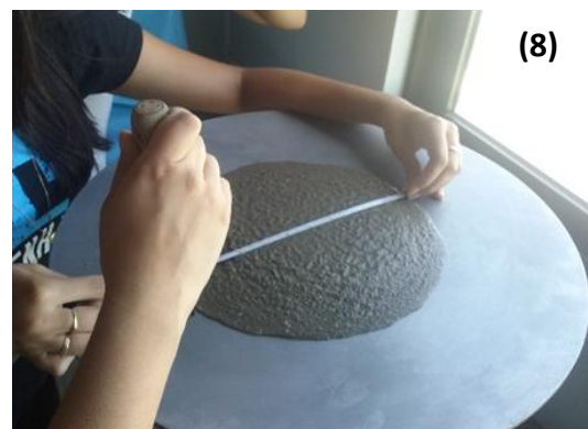
Figuras 7 e 8: Ensaio de consistência no estado fresco na mesa table flow por abatimento.
