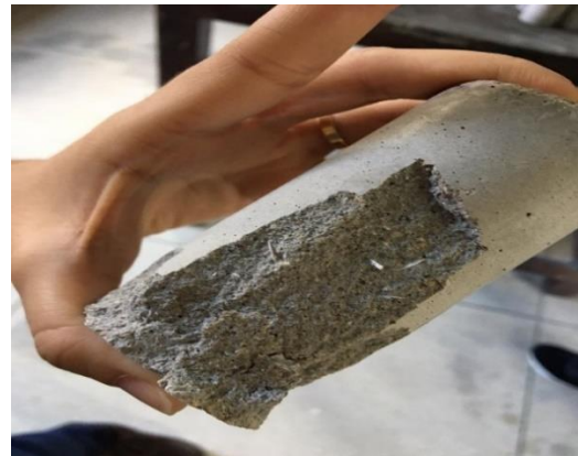
Figura 14: Corpo de prova após o rompimento.
