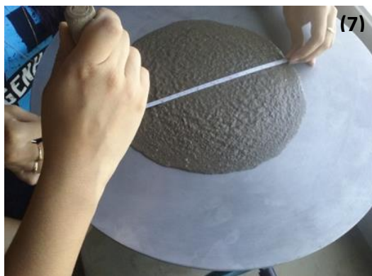
Figuras 7 e 8: Ensaio de consistência no estado fresco na mesa table flow por abatimento.
