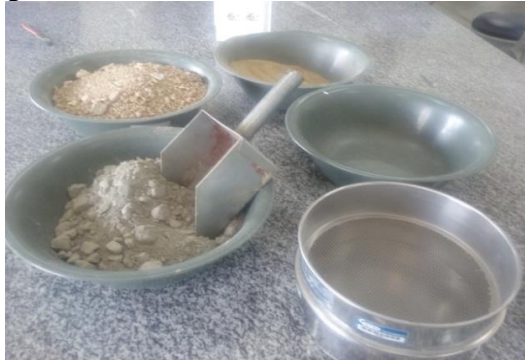
Figura 5: Material agregado e peneiras para granulometria.
