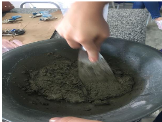
Figura 9: Mistura manual da argamassa com a fibra de vidro.
