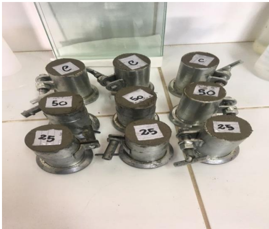
Figura 9: CPs moldados para ensaio de consistência.
