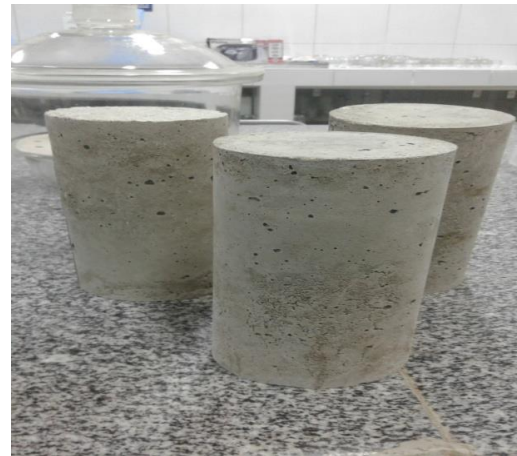
Figura 10: cura a seco dos CPs moldados para ensaio de consistência.
