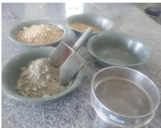
Figura 3: Material agregado e peneiras para granulometria.
